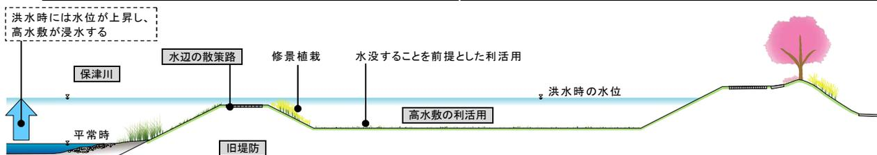
※高水敷は、高さにより、多いところで概ね1～2年に1回程度浸水する(P52参照)
