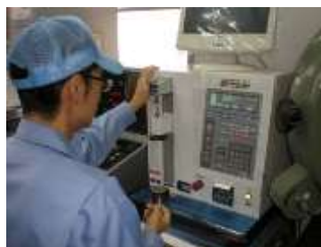
出来上がった『ばね』をテスターで検査しているところ
