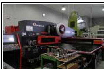
タレットパンチプレス NC制御により成形加工が可能
