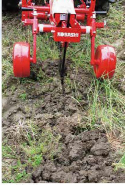
弾丸暗渠の施工
