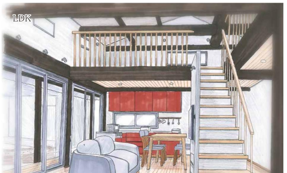
階段下に収納を確保。もともと屋根裏があった場所を抜き、吹き抜けにし、LDKに開放感を持たせた。
