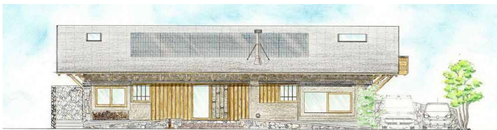
▲医療的ケア児にとって、電源確保は重要。太陽光パネルと蓄電池を設置し災害などの緊急時にも備える。
