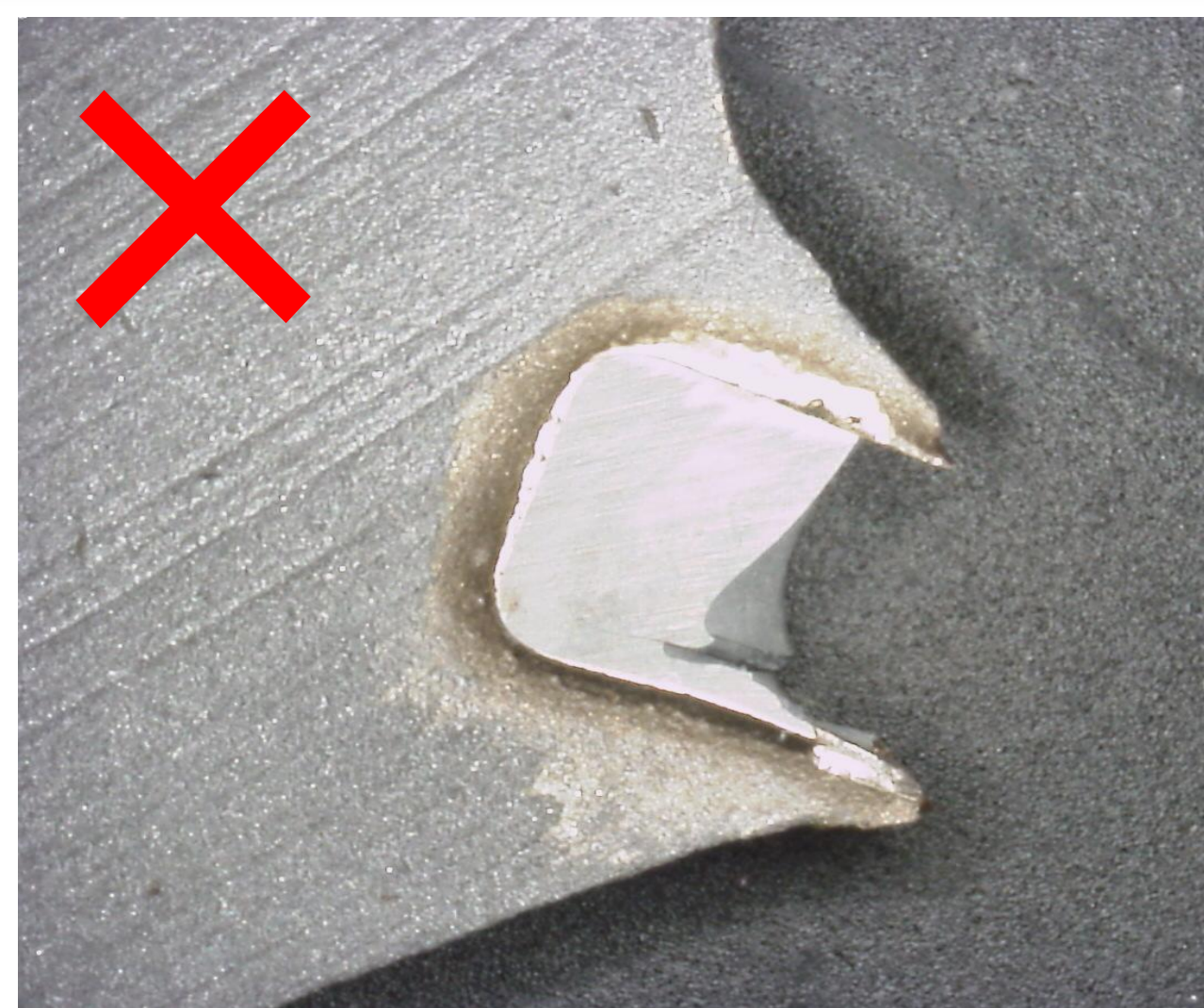
破損したチップ
