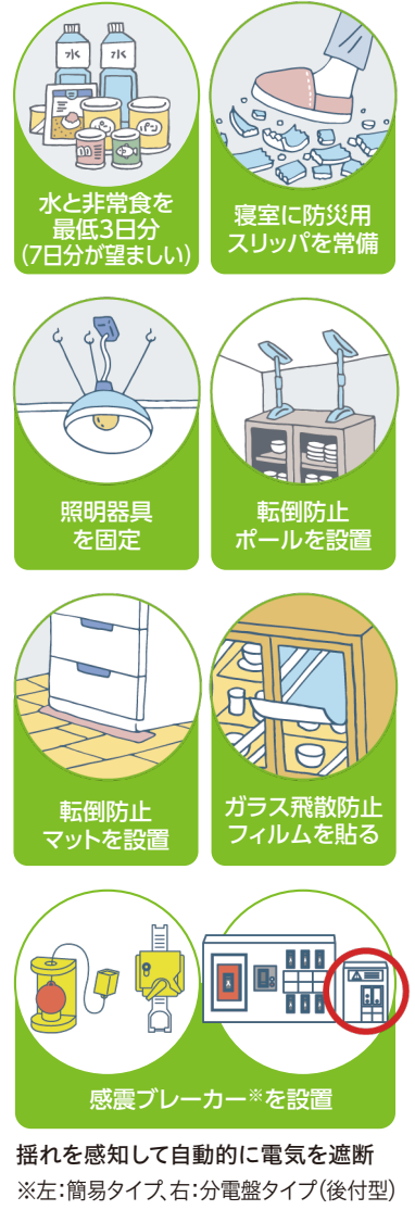
揺れを感知して自動的に電気を遮断 ※左:簡易タイプ、右:分電盤タイプ(後付型)
