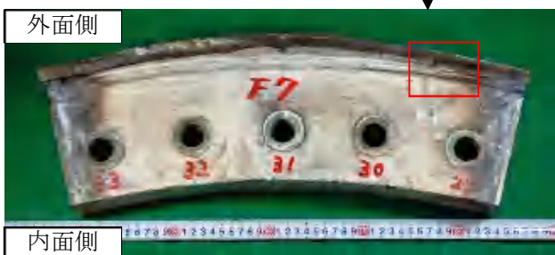
写真8 破面外観および組織・SEM 観察位置 (部位 No. 30)
