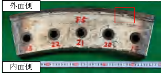
写真1 破面外観および組織・SEM観察位置 (部位 No. 19)
