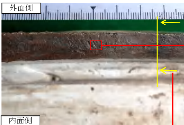
写真9 断面組織観察切断位置
