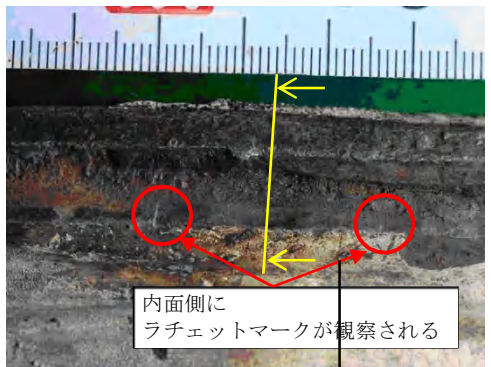
写真6 破面外観 (部位 No. 13)
