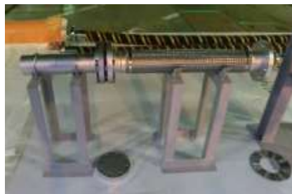
可搬式代替低圧注水ポンプ 吐出配管フランジ接続訓練設備
