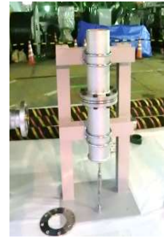
大容量ポンプ海水系統～冷却水系統 接続閉止板入替訓練設備
