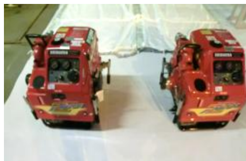
消防ポンプ起動手順訓練設備
