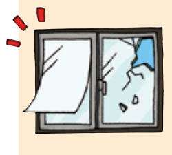
②窓ガラス破損、飛散防止措置
