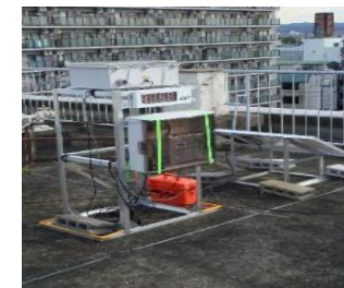
可搬型モニタリングポスト(例) [太陽光パネル+バッテリー付]
