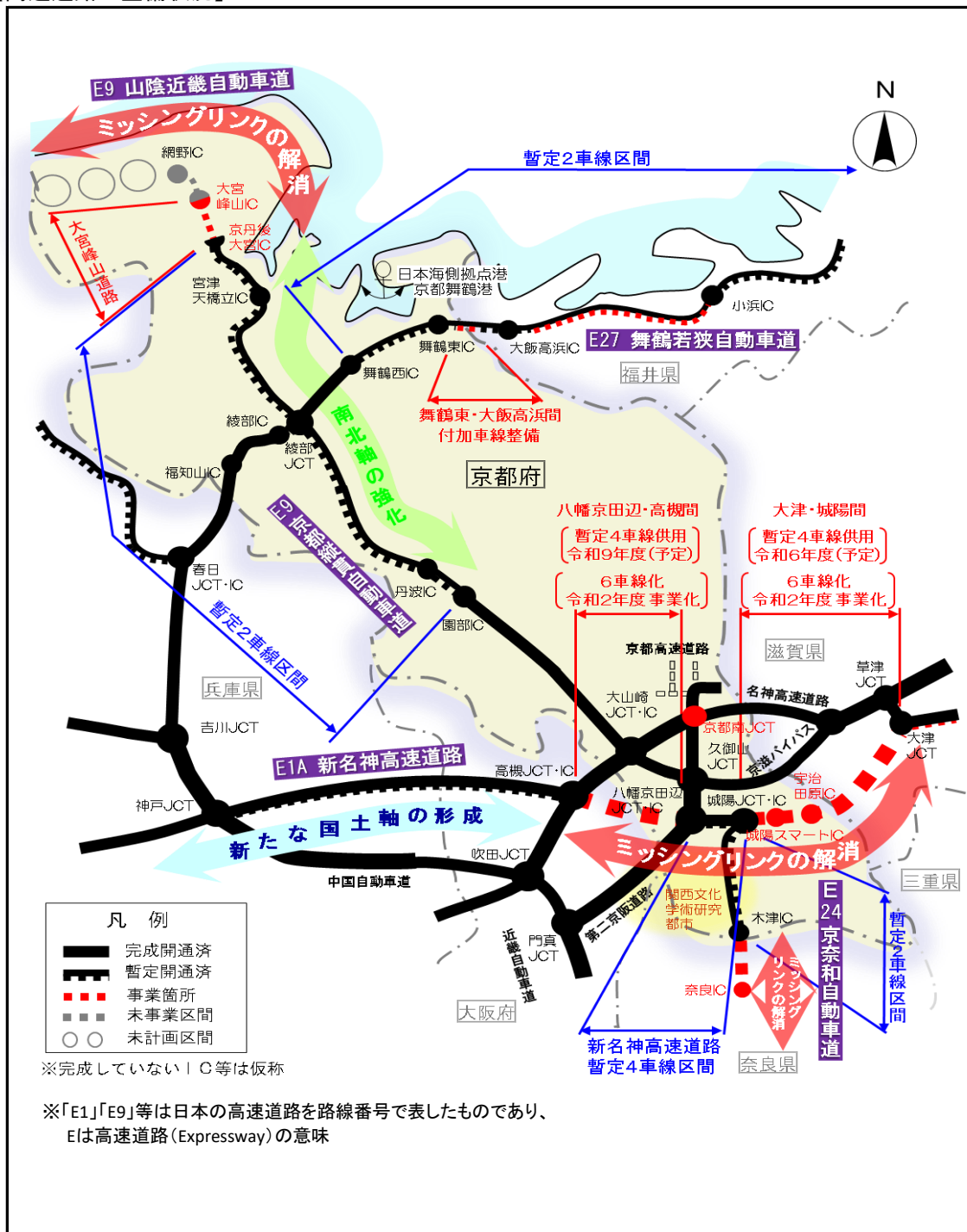
【高速道路の整備状況】
