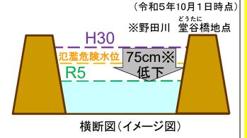
令和5年台風第7号においては、最大24時間降水量が、平成30年7月豪雨を上回ったものの、河道拡幅等の実施により、最高水位を氾濫危険水位以下に抑えられ、内水被害の防止に寄与
