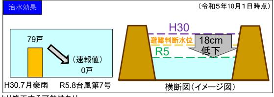
令和5年台風第7号においては、最大3時間降水量が、平成30年7月豪雨を上回ったものの、河道掘削等の実施により、最高水位を避難判断水位以下に抑えられ、家屋浸水被害の防止に寄与
