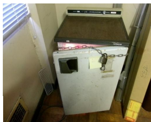
(写真3) 鎖を持ち上げることにより解錠せずとも扉が開く事例
