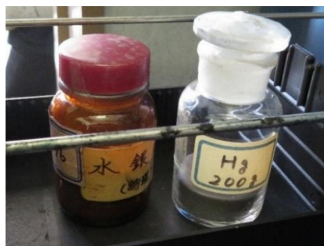
(写真 14) 詰め替え後容器の未表示事例
