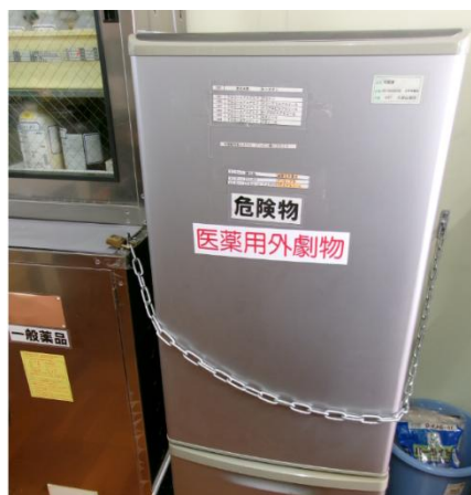
（写真 23）鎖を巻きつけ、他の保管庫や壁に固定することにより、ずれないようにしている事例
