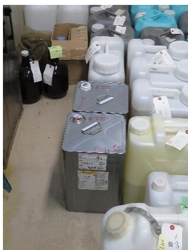
(写真4) 保管室内の床に直接置いている事例
