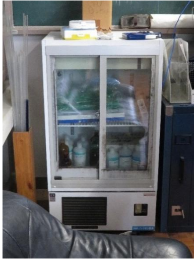
(写真 7) 保管庫(冷蔵庫)内 上段に現像液を保管してい る事例
