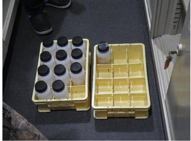
(写真 26) 仕切り付きプラスチックコンテナに収容した保管容器の転倒防止等対策の事例
