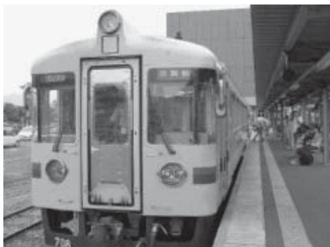
車体カラーは、沿線の海と空をイメージした鮮やかなタンゴブルーに、赤と緑のラインを腰部に配したスタイルで、側引戸および前面貫通扉の外面に無塗装のステンレス板を使用しアクセントとしている。KTR700 型は運用路線が長い点を考慮してトイレを設置し、KTR800 型は主に増結運用とすることからトイレを設置していない。室内の腰掛はすべて 2 人掛の転換クロスシートとなっており、肘掛部と側壁部にはテーブルと灰皿が設けられている。運転室はワンマン運転に対応して左側半室式で、構成は MF100・200 型に準じたものとなっている。
