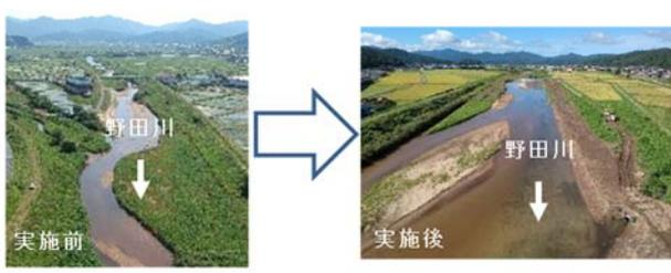
令和5年台風第7号の降水量は、平成30年7月豪雨を上回ったものの、河道掘削、河道拡幅等により最高水位を氾濫危険水位以下に抑えられ、内水被害を防止。
