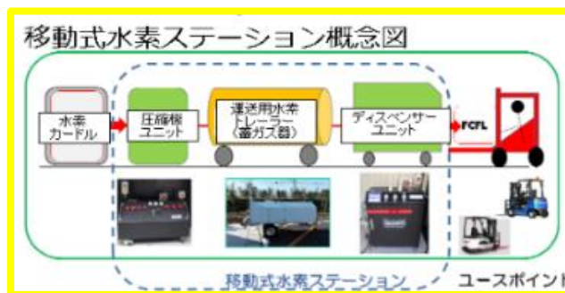
図3-1-14 移動式水素ステーション概念図
