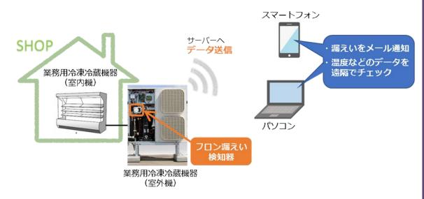
一般的に、使用中の冷凍空調機器からのフロン類の漏えいに気付くのは、冷凍空調機器の温度管理に異常をきたしたとき(充塡量のおおむね6割が漏えい)であると言われていますが、冷媒フロン漏えい検知器を導入することにより、漏えい量が3割に至るまでの早い段階で漏えいを検知し、速やかに修理することができるため、地球温暖化対策になるだけでなく、電気代の節約、製品在庫ロスの発生防止、機器の長寿命化等につなげることができます。府では引き続き中小企業のフロン類排出抑制対策を支援していきます。
