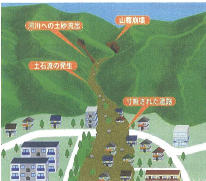
土石流は下流人家等に大きな被害を生む
