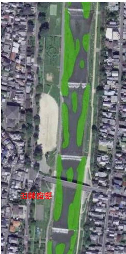
出雲路橋上流では平成8年度に中洲の除去が行われました。その後、約10年が経過して中洲が形成され、植物の繁茂によって土砂が流れにくい状態になっています。
