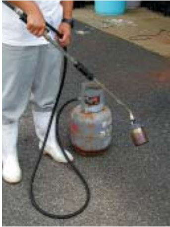
写真3 付着生物除去に用いた大型バーナー
