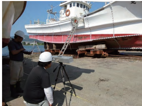
図7 ステレオカメラによる 漁船形状の測定
