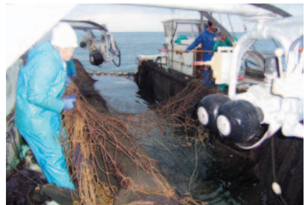
写真7 魚捕部に設置された敷網（選別網）
