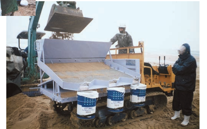
京都府が開発した重油回収機：砂油離号
