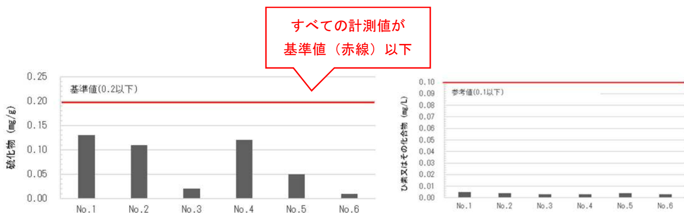
【図-17 底質の変化（左：硫化物、右：ひ素又はその化合物）】
