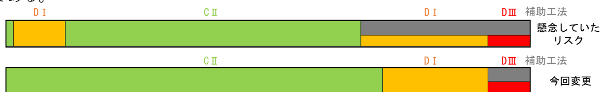
【図-13 懸念されていたリスクと今回変更した支保構造】
