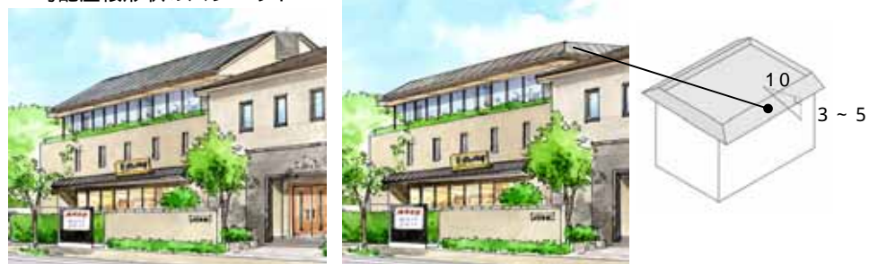
勾配屋根形状のパラペット
