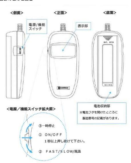
電源/機能スイッチは、上・下のスライドとプッシュの3方向で操作します。
