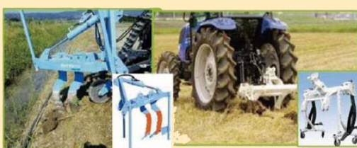
排水改良等の作業機(補助暗渠)の導入 (写真左はカットドレーン、写真右はサブソイラ)※
