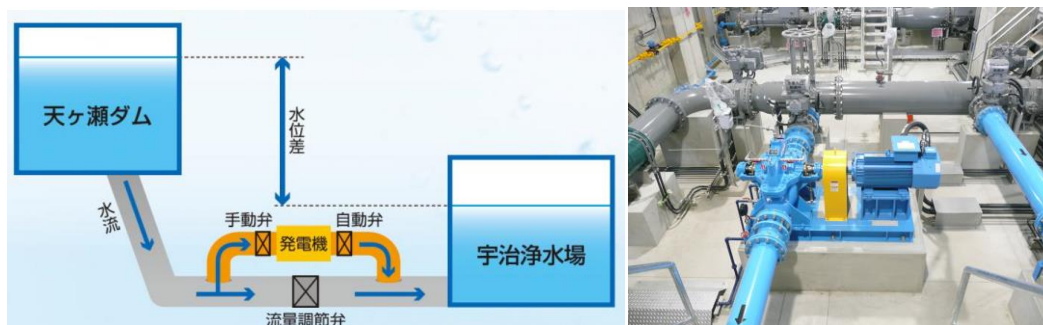
図6 京都府宇治浄水場の小水力発電（発電出力：63kW）の仕組み
