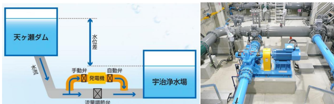
図 12 宇治浄水場の小水力発電の仕組み
