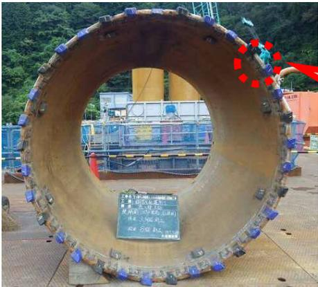
先端のビット摩耗・欠損
