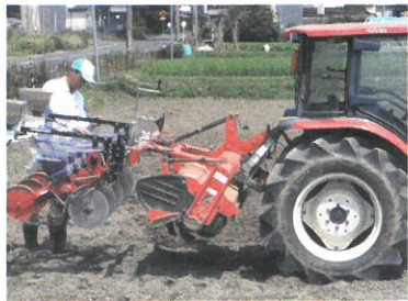
「京力農場づくり事業」で導入した播種機による小豆の播種作業
