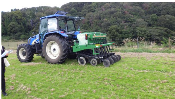
不耕起播種機 (耕起、播種、鎮圧同時作業)
