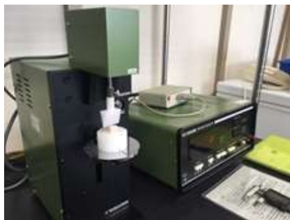
レオメーターによる剪断力価測定
