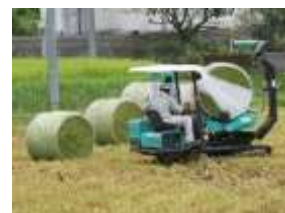
ラッピングマシンで密封 1個当たり300kg直径100cm
