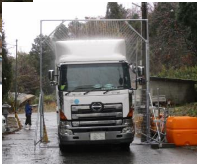
設置装置による大型車両消毒の様子
