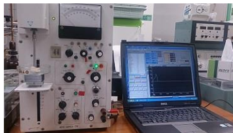
硬さを測定するレオメーターを用いた分析
