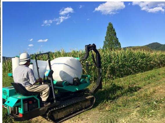
筒状に成形した細断したトウモロコシをベールラップ（白いラップで巻く機械）で包装・密閉します
