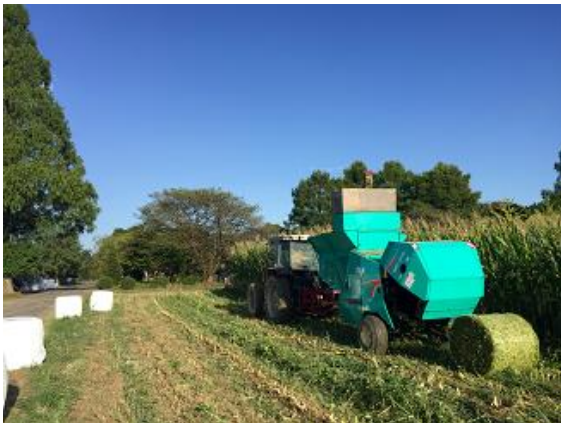
大型トラクターに取り付けたコーンハーベスタ（刈取・細断機）で刈り取り、ロールペーラ（成形機）で筒状に成形します
