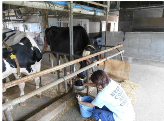
飲み水の温度を測定し、地中配管による水温低下効果を調査
