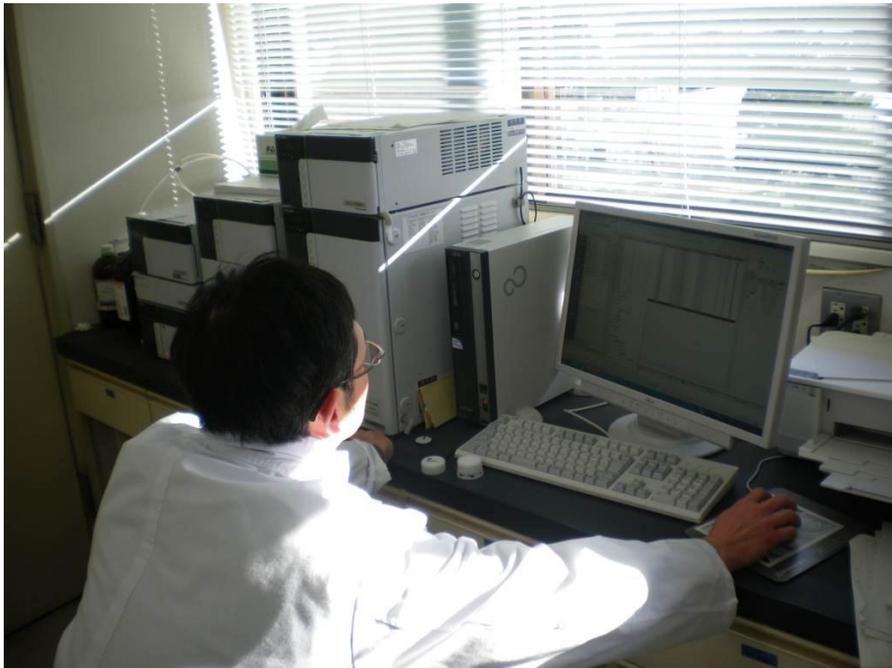
分析機器（液体クロマトグラフィー）によるビタミンA測定
