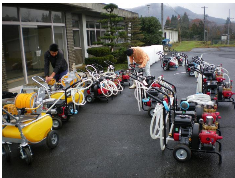
動力噴霧器の作動確認
