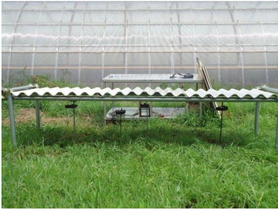
屋根材裏面からの放射熱量を測定
