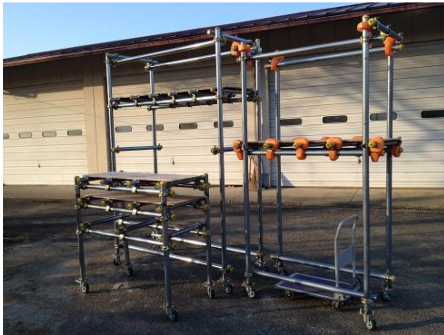
作業床の高さが 2m(後列左) と 1.5m(後列右)の足場と実験用ミニチュア(前列)
