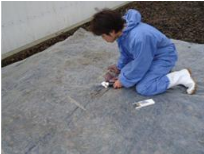
脱臭装置を通過した空気中のアンモニアガス測定
