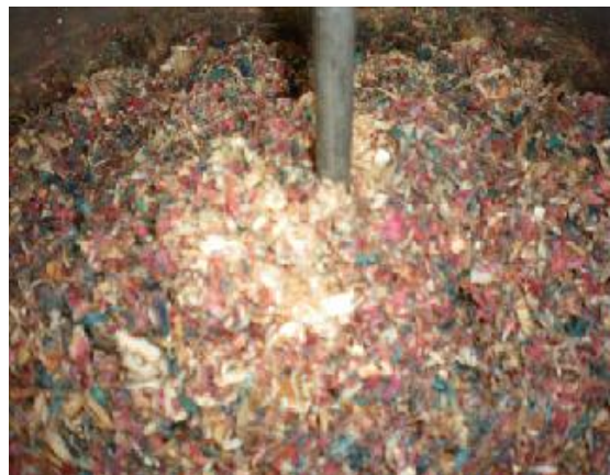
攪拌混合試験 (120 分後に均一化)
