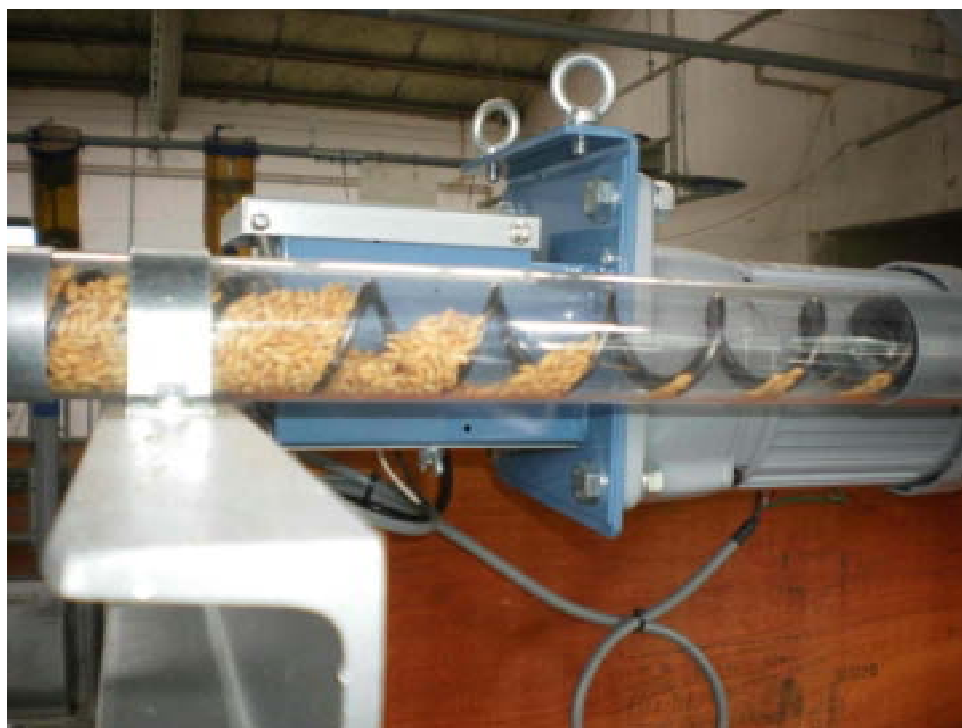
給餌ラインを想定したスクリーコンベア実験装置で籾米の搬送状況を確認
