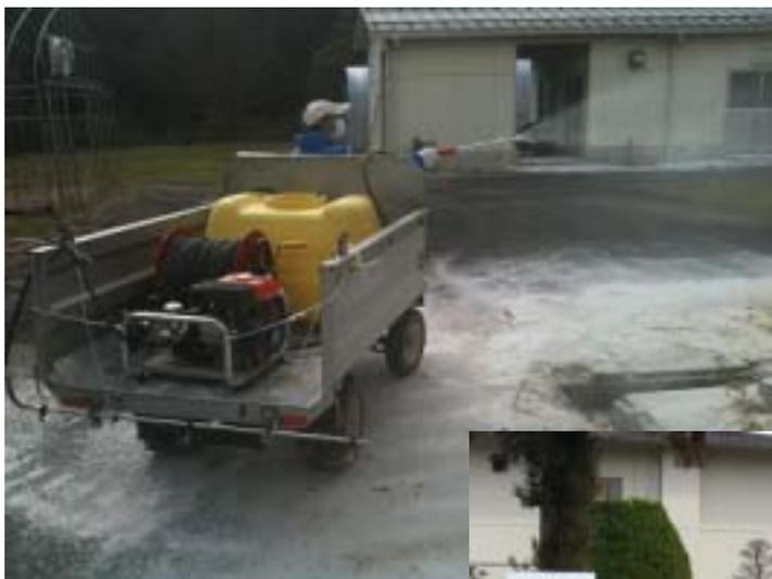
噴霧装置を運搬車の後部に設置し手動と併わせて消毒液を噴霧（鶏舎敷地）
